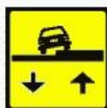
Denivelare față de banda alăturată
