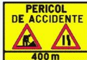
Presemnalizarea unui sector cu circulație alternantă
