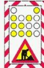
Semnalizarea unui utilaj care se deplasează lucrând
